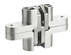
型号：RKA009(锌合金弹簧暗铰) 尺寸：25X118X18mm 说明：内置弹簧，有自动闭门功能 但闭门力不可调节
